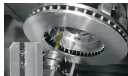
Lavorazione dei dischi freno tramite IVS
