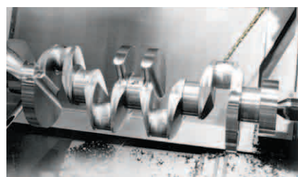
Lavorazione degli alberi motore tramite INTEGREX
