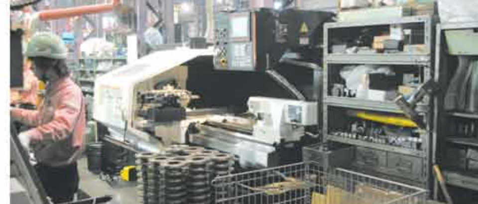
Станок M4 (1500L), разработанный для высокоэффективной обработки крупногабаритных, длинных заготовок
