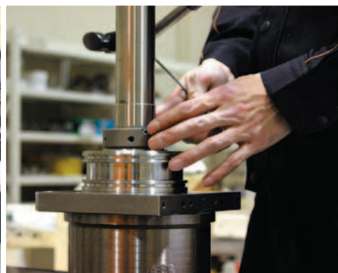
熟練エンジニアによるスピンドルの組み付け作業
