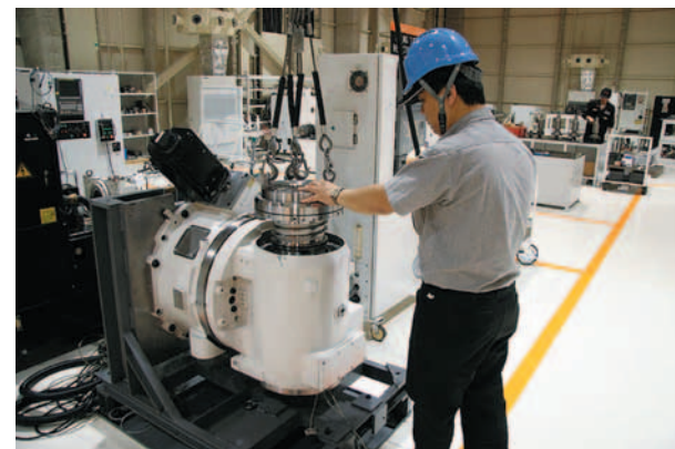
試運転台にセットされるスピンドルカートリッジ。修理品でも新品同様の品質検査をして出荷
