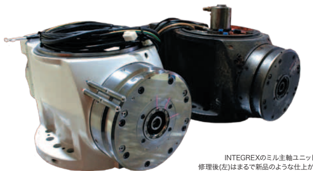
試運転台にセットされるスピンドルカートリッジ。修理品でも新品同様の品質検査をして出荷
