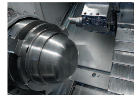
Bearbeitung des Topfes aus Nanbu-Gusseisen
