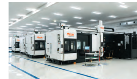
Linha de FMS da série INTEGREX i instalada na Fábrica dos sonhos da Sankyo
