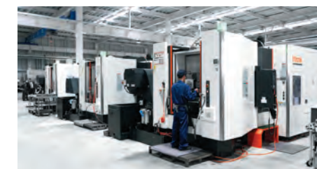
Usinagem de peças pequenas com HCN
