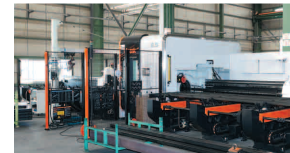
用于钢管3维加工的3D FABRI GEAR 220 II
