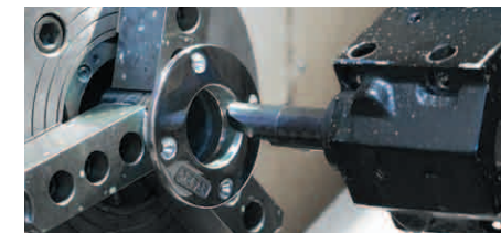
精密铸件的内径精加工
