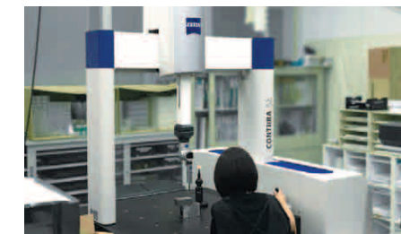
Una macchina di misura delle coordinate (CMM) venne installata per garantire la massima precisione
