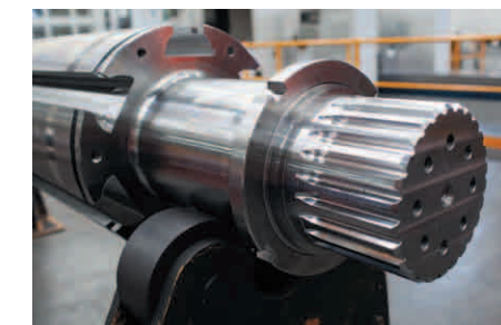
Dettaglio delle scanalature e delle cavità sull'albero della calibratrice FLSmidth ABON
