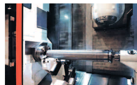
INTEGREX e-500H II lavora i rulli con un'unica configurazione macchina
