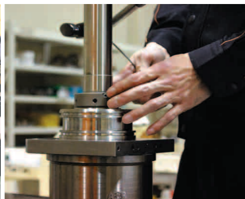
Spindelmontage durch einen erfahrenen Fachmann
