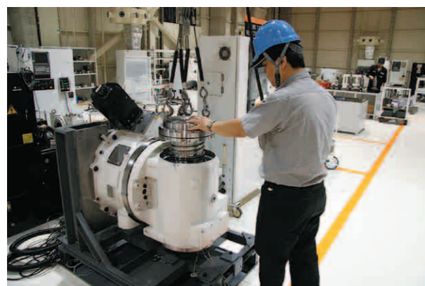
Fräsen einer Spindelkartusche auf einem Prüfstand
