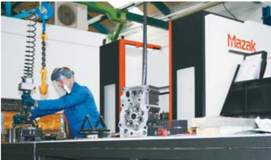
Un operatore intento a rimuovere una complessa testa cilindri da una delle nuove macchine HORIZONTAL CENTRE NEXUS 6000-II di John Hyde Engineering.
