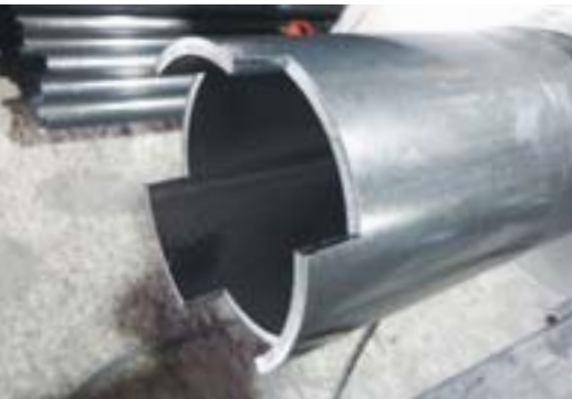
Tubo in acciaio tagliato dalla 3D FABRI GEAR 220 II
