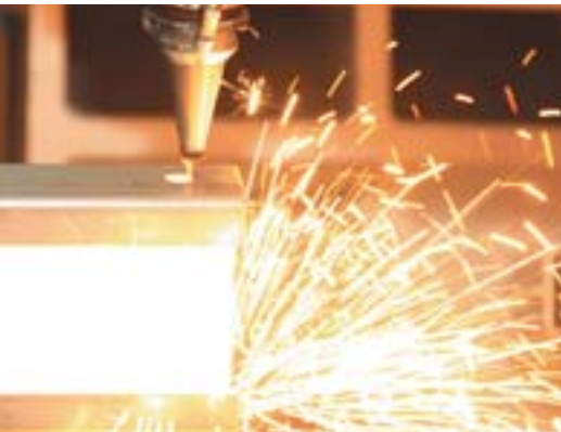
Taglio laser con 3D FABRI GEAR 220 II
