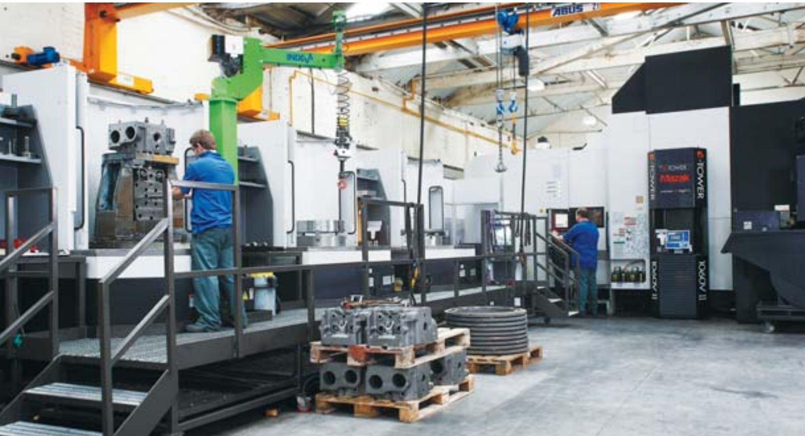
Il FLEXIBLE MANUFACTURING SYSTEM (FMS) di John Hyde Engineering, abbinato ad una INTEGREX e-1060V II.
