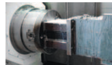
Von Austbore gefertigte Spannvorrichtung zur Anbringung am Maschinenspannfutter zwecks weiterer Verbesserung von Arbeitseffizienz und Bearbeitungsgenauigkeit
