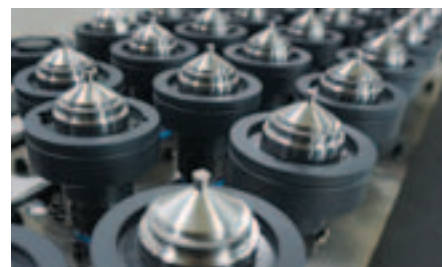
Auf einer QUICK TURN SMART bearbeitete Heißkanaldüsen
