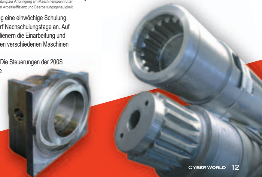
Von Austbore gefertigte Spannvorrichtung zur Anbringung am Maschinenspannfutter zwecks weiterer Verbesserung von Arbeitseffizienz und Bearbeitungsgenauigkeit
