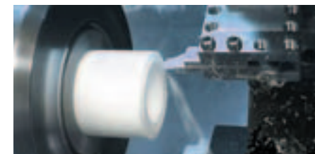
Drehen mit einem handgeschliffenen Werkzeug
