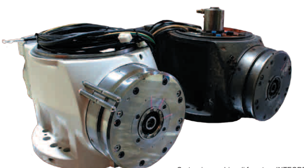
Cartuccia mandrino di fresatura INTEGREX La cartuccia riparata (sinistra) ha lo stesso aspetto di una cartuccia nuova
