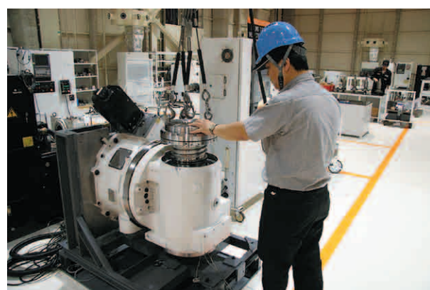
Cartuccia di un mandrino di fresatura sul banco prove
