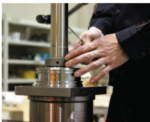
Assemblaggio di un mandrino da parte di un tecnico qualificato
