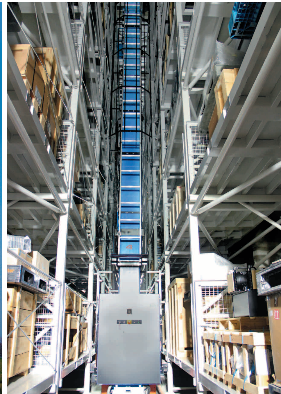
Il World Parts Center dispone di gru di stoccaggio verticali per i ricambi a medie-grandi dimensioni e di sistemi automatici di stoccaggio verticali ad alta velocità per i ricambi di piccole dimensioni
