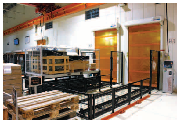
Ricambi di grandi dimensioni immessi nei sistemi di stoccaggio automatici verticali ad alta velocità
