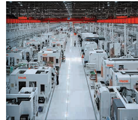
LED照明や最新空調とエネルギー管理システムにより 美濃加茂製作所第一工場ではCO 2 排出量を約30%削減
