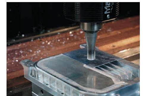
アルミニウム製冷却パネルの高速摩擦攪拌接合
