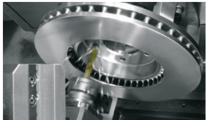
Usinagem de disco de freio por IVS
