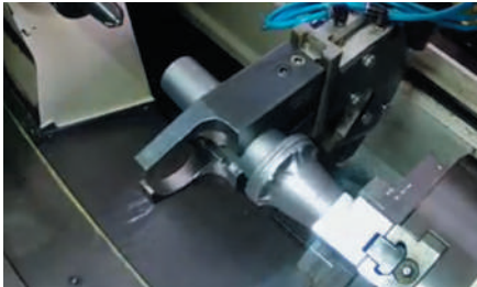
Automação da fixação e remoção da peça por mãos robóticas
