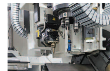
タップユニットとタッチセンサにより、さらなる工程集約を実現
