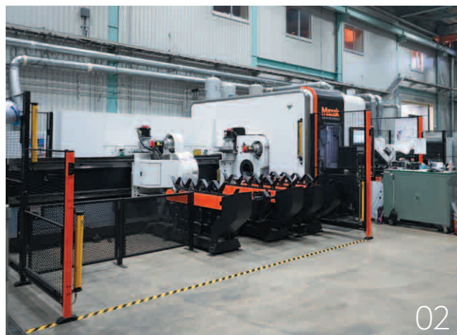
01. Etêteuse-évideuse automatisée qui transforme entièrement et automatiquement le saumon (à gauche) et "Kaihyo", un système qui produit instantanément de petits cristaux de glace 02. Les barres de châssis des machines sont découpées par un 3D FABRI GEAR 03. L'efficacité du travail a été considérablement améliorée par la découpe laser 04. M. Atsushi Sato, président (au centre, première rangée) et ses employés
