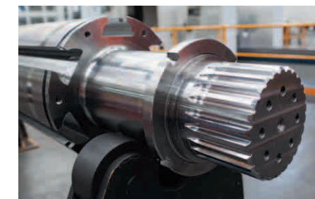
Vue en détail du profil cannelé et des clavettes sur un arbre de classificateur de FLSmidth ABON
