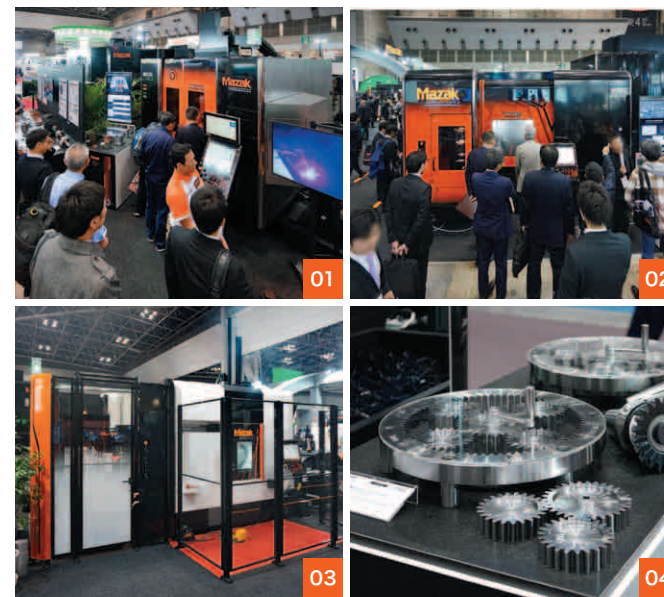
01. VARIAXIS J-600/5X AM (Blue laser), qui peut effectuer la fabrication additive du cuivre pur 02. INTEGREX I-200 AG, avec fonctions intégrées de mesure et de taillage d'engrenages 03. QUICK TURN 200M, équipé du système d'automatisation GL-50 04. Exemples de pièces produites par un INTEGREX AG
