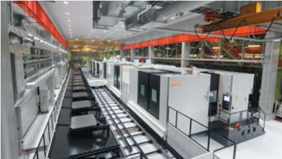
Nouveau système d'automatisation pour l'usinage de grandes pièces (usine d'Oguchi, Japon)
