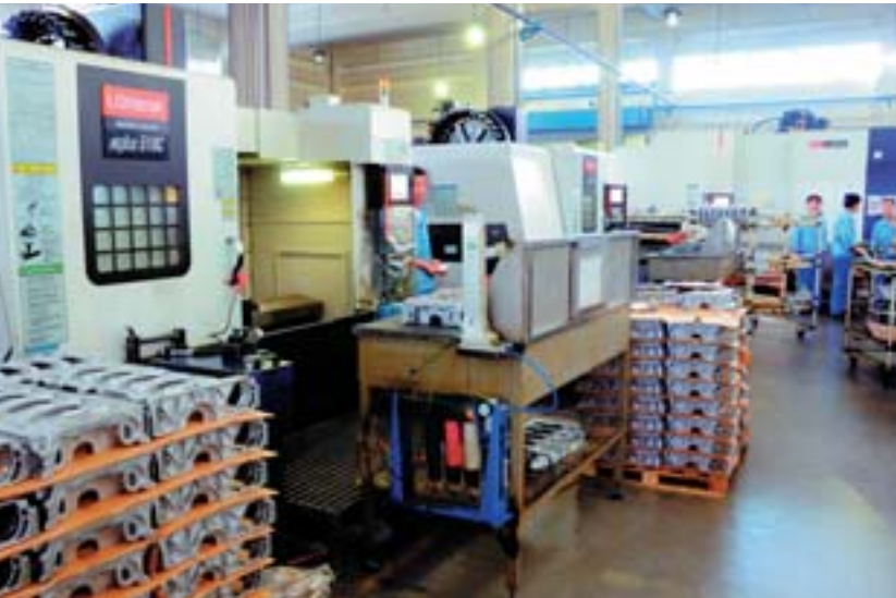
Chaîne de production avec les centres d'usinage verticaux fabriqués par LG Mazak
