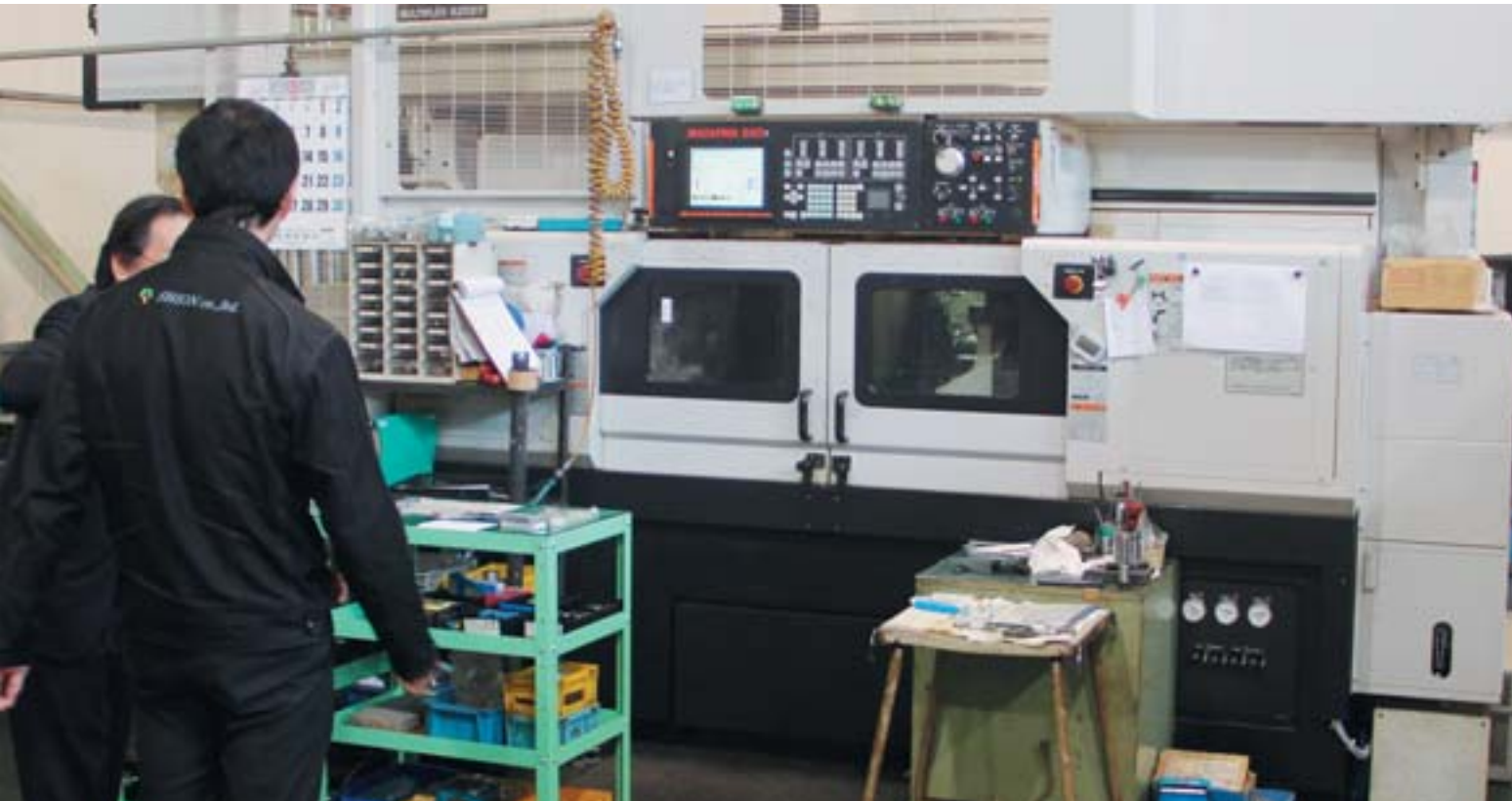
Centre de tournage CNC multitâches MULTIPLEX 6200-II Y avec système de chargeur à portique
