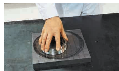
ラッピング盤上でスペーサー端面を研磨するラッピング作業
