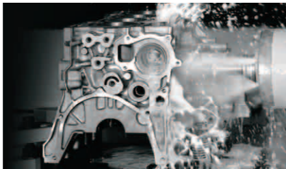
Bearbeitung eines Zylinderblocks mit der FF
