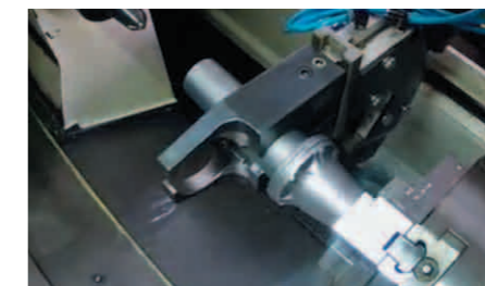
Automatisierung des Auf- und Ausspanns der Werkstücke mittels Robotergriffen
