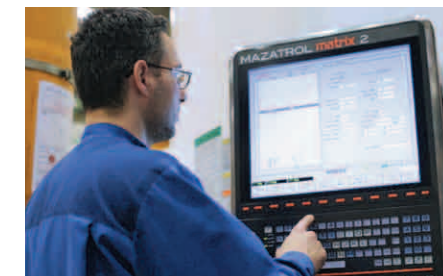
Facilité d'utilisation grâce à la commande CNC Mazatrol avec programmation conversationnelle
