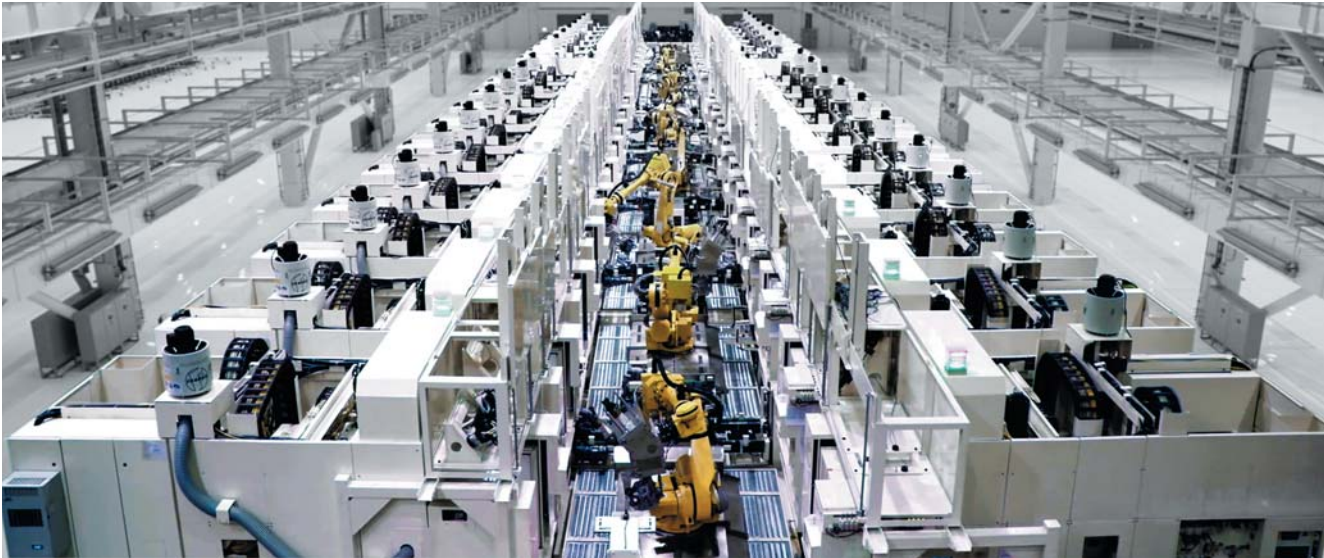
Линия массового производства деталей автомобильных двигателей, состоящая из горизонтальных обрабатывающих центров FF 5000/40 и управляемых роботов
