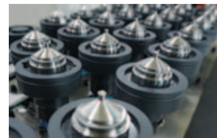
Ugelli dei canali caldi lavorati da un tornio QUICK TURN SMART
