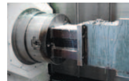
L'attrezzo da fissare sull'autocentrante della macchina realizzato da Austbore migliora l'efficienza operativa e la precisione della lavorazione
