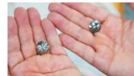
通过INTEGREX j-200进行58面切削(多面形刻法)
