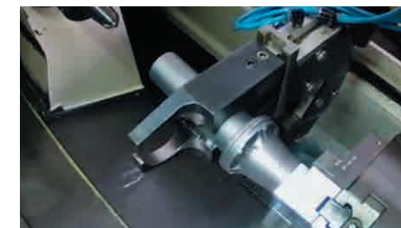
ロボットハンドによりワークの着脱を自動化
