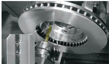
IVSによるブレーキディスク加工
