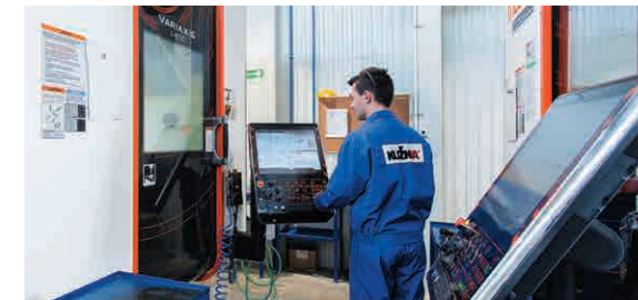
複雑形状加工のスピードと精度を追求するため、最新の5軸加工機を導入
