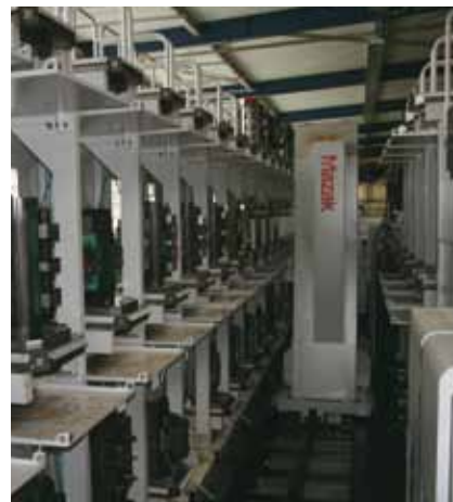
3-уровневая система PALLETECH, обеспечивает гибкость применения и возможность круглосуточной эксплуатации станков
