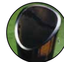
Поперечный срез, выполненный методом трехкоординатной контурной обработки
