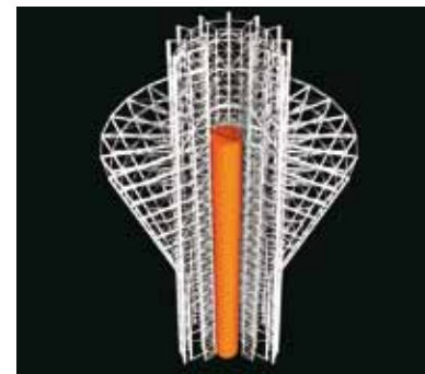
Конструкция вокруг центральной колонны (синбасира): колонна построена особым методом: путем непрерывной заливки бетона после сооружения каркаса.
