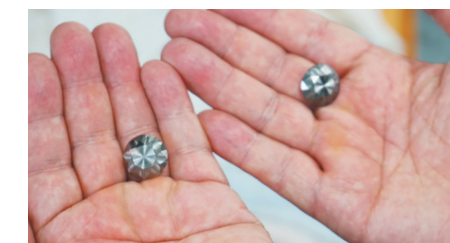
58 facetas de usinagem de superfície do espelho pelo INTEGREX j-200
