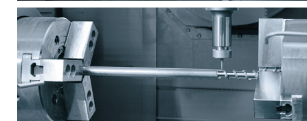
O segundo spindle do INTEGREGX desenha a peça para o comprimento programado a fim de conseguir um tempo de usinagem menor e uma usinagem de fusos de alta precisão
