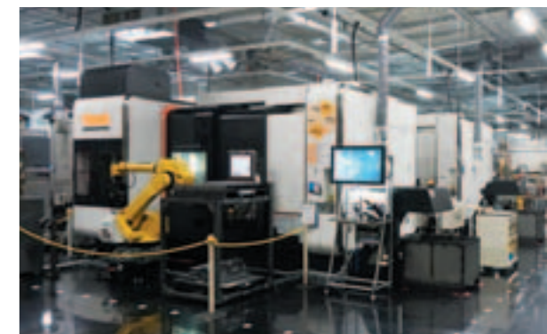
Sistema automatizzato costituito da due INTEGREX e da due robot
