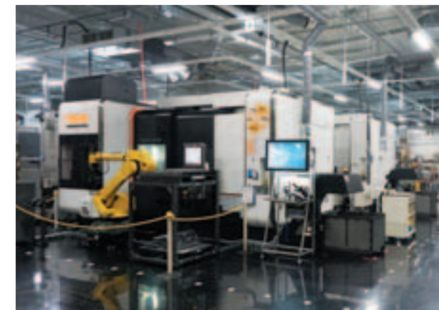
Automatisierungssystem, bestehend aus zwei INTEGREX-Maschinen und zwei Robotern
