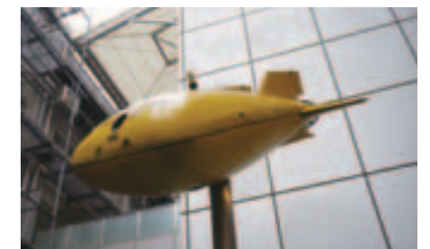
PTEROA 150, autonom operierender Unterwasserroboter, der auf Mazak-Werkzeugmaschinen gefertigt wurde.
