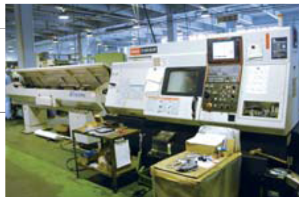
ミル付きのCNC旋盤QUICK TURN NEXUS 200-II MSY
