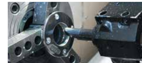
Финишная обработка внутренней части литой детали
