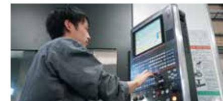
Внезапные изменения в программе обработки легко корректировать с помощью ЧПУ MAZATROL
