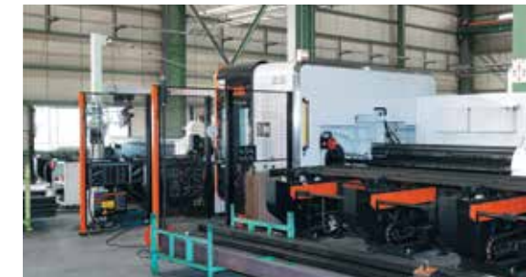
Станок лазерной резки 3D FABRI GEAR 220 II используется для резки стальных труб
