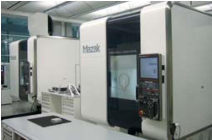
Due HYPER VARIAXIS 630 utilizzate per la lavorazione dei componenti delle macchine da corsa
