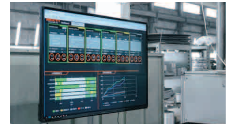
SMOOTH MONITOR permet de visualiser les données des machines pour l'analyse et l'amélioration de la productivité
