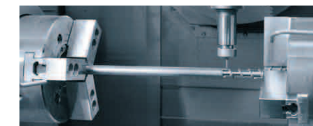
La broche secondaire de la machine INTEGREX extrait la pièce sur une longueur préprogrammée pour raccourcir le temps de coupe et usiner avec grande précision
