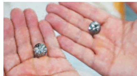
Taille diamant à 58 facettes avec finition miroir sur INTEGREX j-200
