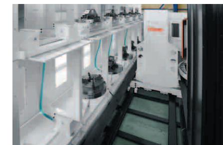
Sistema PALLETECH installato per ridurre ulteriormente i tempi di produzione
