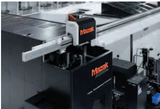
Gli utensili vengono forniti automaticamente a più macchine
