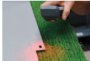
L'operatore richiama il programma di piegatura scansionando i codici QR tracciati sui pezzi
