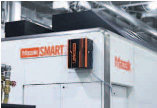
Tutti i dati delle macchine vengono raccolti tramite le unità MAZAK SMARTBOX™ situate in vari punti dell'area di lavorazione
