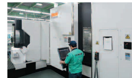
Il centro di lavoro orizzontale Mazak HCN-6000 con cambio pallet a 6 posizioni funziona in modo non presidiato per periodi di tempo prolungati
