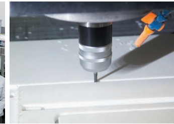
5軸加工機による半導体製造装置向け部品の加工
