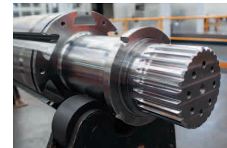
スムーズギアホッピング機能によるスプライン加工を施されたシャフト
