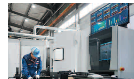
Das Smooth Monitor AX-Datensichtgerät (oben rechts gezeigt) vereinfacht den zentralen Zugang zu den Statusdaten
