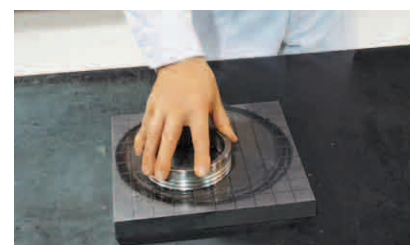
Läppen – Abschließende Präzisionsbearbeitung von Distanzstück-Stirnflächen durch Läppen
