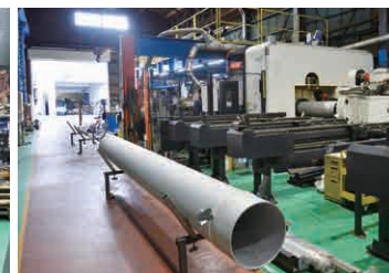
最大加工径 Φ406.4 mmのパイプを加工
