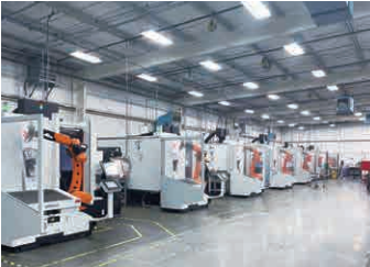
マザック機とロボットアームの組み合わせで自動化を図る
