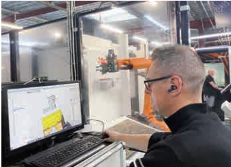
MAZAK CAD/CAMシステムで サイクルタイムの最適化を図る
