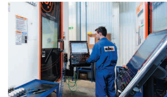
Centres d'usinage 5 axes à grande vitesse et haute précision mis en place pour les pièces complexes
