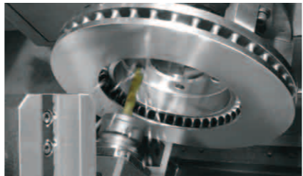
Usinage d'un disque de frein avec l'IVS
