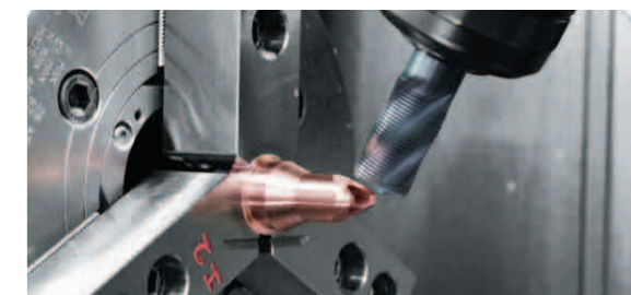
Des pièces complexes sont usinées à partir du cuivre et de divers autres matériaux
