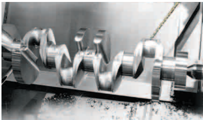
Usinage d'un vilebrequin avec l'INTEGREX
