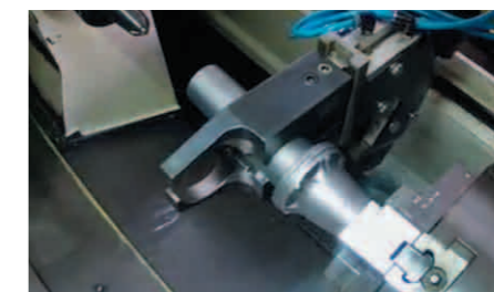
Automatisation du chargement/déchargement de la pièce par robot
