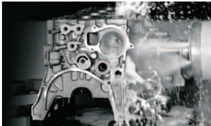
使用FF加工气缸缸体
