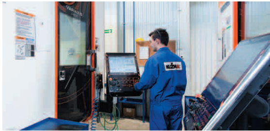
加工复杂形状零件时，为了追求加工速度与精度，引进了最新的5轴加工设备
