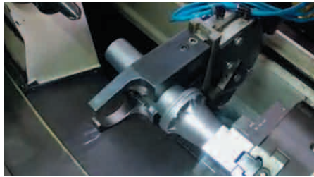
利用机械手实现了工件自动装卸
