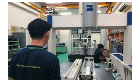
Un sistema di garanzia della qualità è stato istituito con l'introduzione di macchine di misurazione 3D e di altro tipo
