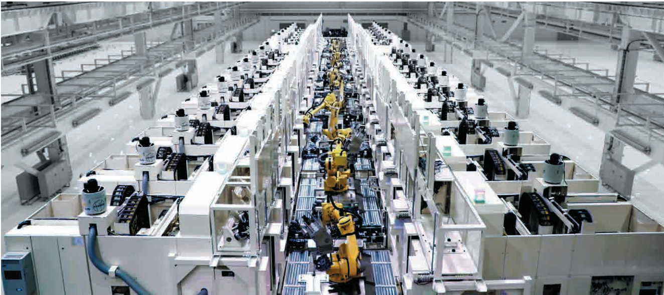
Linea di produzione di massa per la lavorazione di parti di motori automobilistici, costituita da centri di lavoro orizzontali FF-5000/40 e robot antropomorfi
