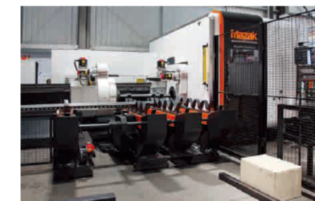
La macchina 3D FABRI GEAR svolge un ruolo attivo nella lavorazione dei telai delle macchine da palestra
