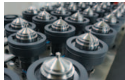
Buses de systèmes à canaux chauds usinés par un QUICK TURN SMART
