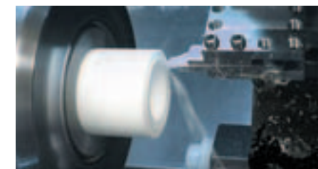
Tournage avec un outil rectifié à la main
