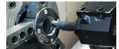
Schlichtbearbeitung eines im Wachsaußschmelzverfahren hergestellten Gussteils von innen
