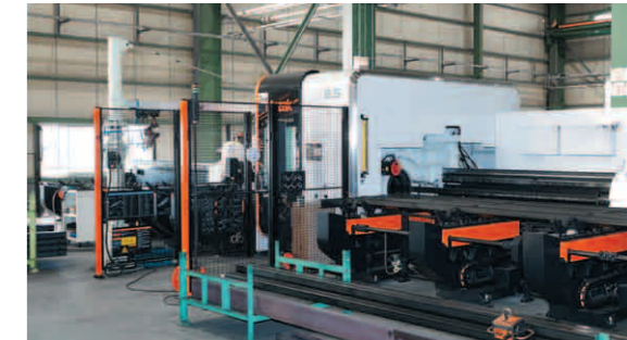
3D FABRI GEAR 220 II wird zum 3D-Schneiden von Stahlrohren eingesetzt
