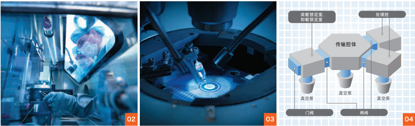
01. 大量排列着半导体制造装置的最尖端半导体工厂 ( 洁净室 ) [ 提供 : 东芝存储器株式会社 ] 02. 用于阻断氧和水的“手套式操作箱”内的作业 03. 硅晶片的电气性能检查 04. 制造装置内的集束室模式图
