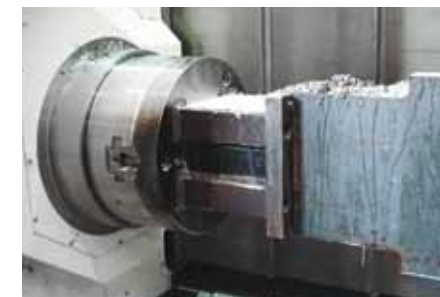
Придуманное в компании Austbore крепление, которое ставится на патрон станка, дополнительно увеличивает эффективность эксплуатации и
