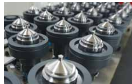
Литейные отверстия подогреваемых литников, обработанных на токарном центре с ЧПУ QUICK TURN SMART
