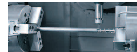
INTEGREXの第二主軸でワークを引き出す「尺取り」により、スクリーの加工時間削減と高精度加工を両立
