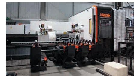
웨이트 머신의 프레임 가공 등에서 3D FABRI GEAR 220 II가 활약
