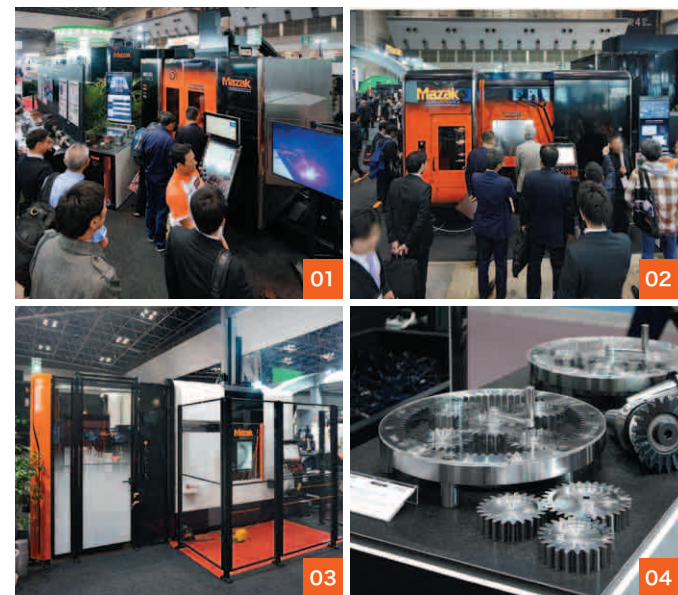
01. 可进行纯铜的层积造形的“VARIAXIS j-600/5X AM（Blue Laser规格）” 02. 结合了齿轮加工和测量功能的INTEGREX i-200 AG 03. 搭载了自动化系统GL-50的“QUICK TURN 200M” 04. “INTEGREX AG”所加工的样品
