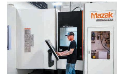
连接在PALLETECH HIGH-RISE SYSTEM上的HCN-5000实现了24小时连续加工
