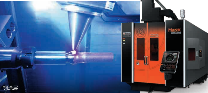
搭载了高辉度蓝色半导体激光多光束加工头的机床
