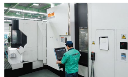
Centro de usinagem horizontal da Mazak HCN-6000 com um trocador de 6 pallets realiza operações automatizadas durante longos períodos de tempo
