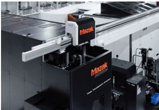
As ferramentas são fornecidas automaticamente a várias máquinas
