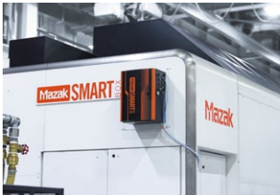
Todos os dados das máquinas são coletados usando o MAZAK SMARTBOX™ implantado em diferentes locais da área de usinagem
