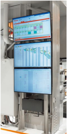
Os telões instalados na área de montagem exibem o progresso dos processos em tempo real
