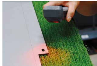
O operador chama o programa de processamento de curvatura digitalizando os códigos QR descritos nas peças de trabalho
