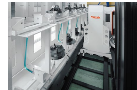
O sistema PALLETECH instalado para reduzir o tempo de produção
